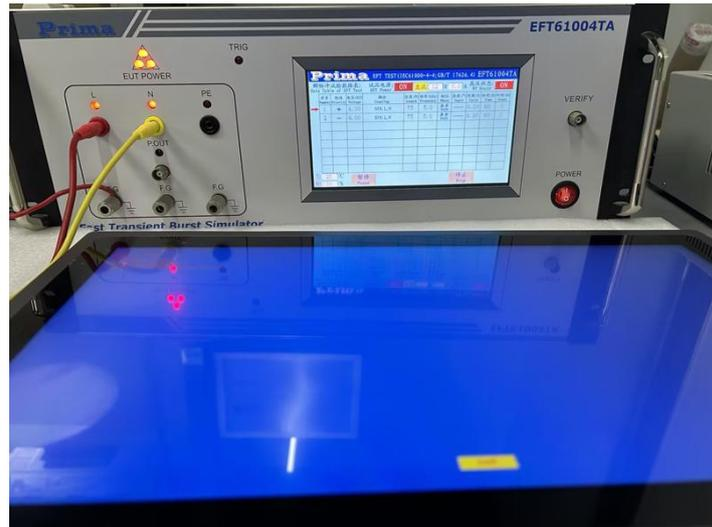
图 6-4 群脉冲测试图
