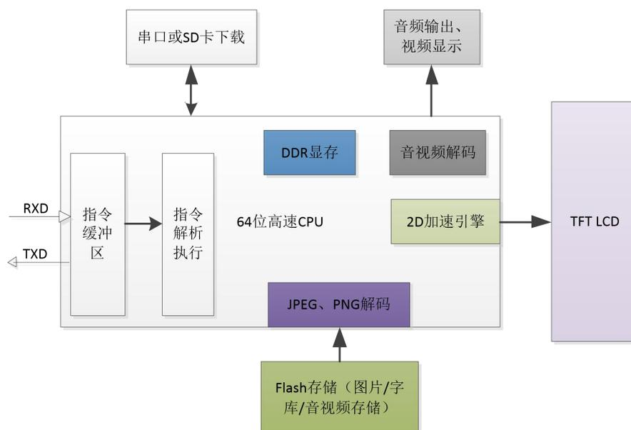
图 3-1 DH 系列串口屏内部结构图
