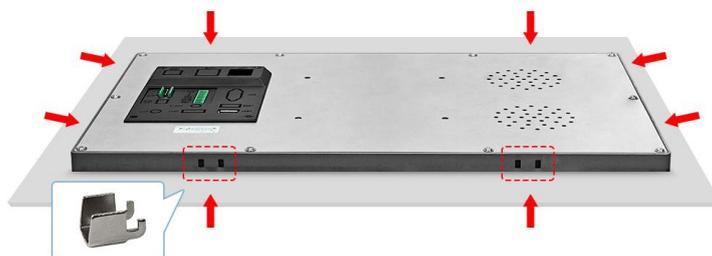
**第二步：将卡扣插入如图红色标识位置的安装孔中**
