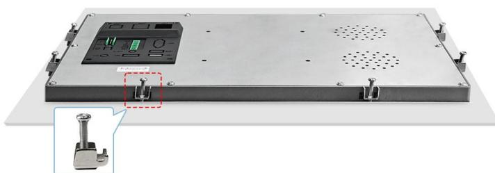
**第三步：将螺丝垂直拧紧，固定串口屏到客户机柜上**
