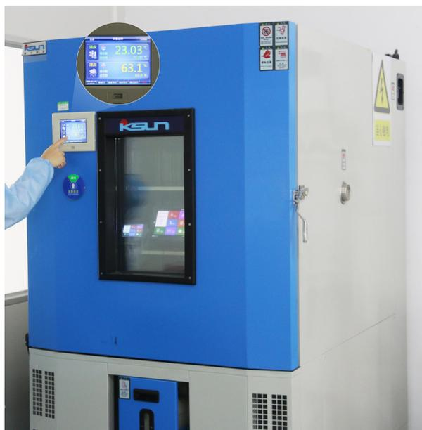
图 6-3 高低温老化测试图
